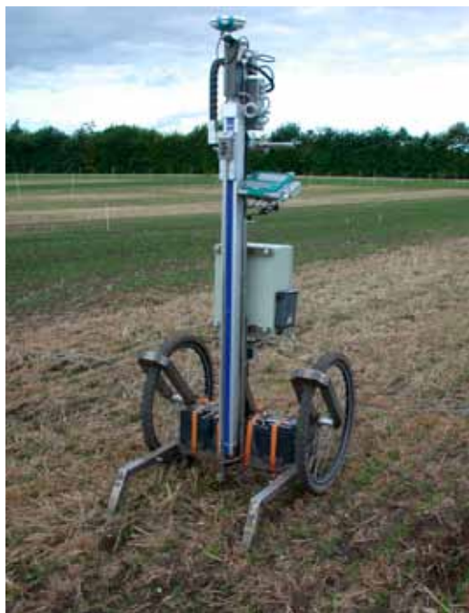
Penetreringsmodstand måles med dette mobile apparat. Et stålspyd med 30 grader spids og maksimum diameter på 2 cm presses med en konstant hastighed på 30 mm pr. sekund ned til 1 meters dybde. (Foto: Stig T. Rasmussen, Aarhus Universitet).
