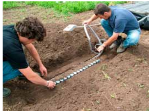
Tryk i trædefladen måles ved hjælp af et "batteri" af trykmålere, limet på en gummidug og lagt ned i jorden i cirka 10 cm dybde og løs jord genplaceret over trykmålerne. (Fotos: Per Schjønning, Aarhus Universitet).
